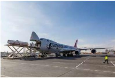
また、旅客機は通常、機体側面から貨物を積載するため、搭載できる貨物の長さにも制限がありますが、カーゴックスは B747 の貨物専用機ですので、機首（操縦席付近）からまっすぐ貨物を積載できるため、最大 50 メートルの長さの品物を航空輸送できます。
